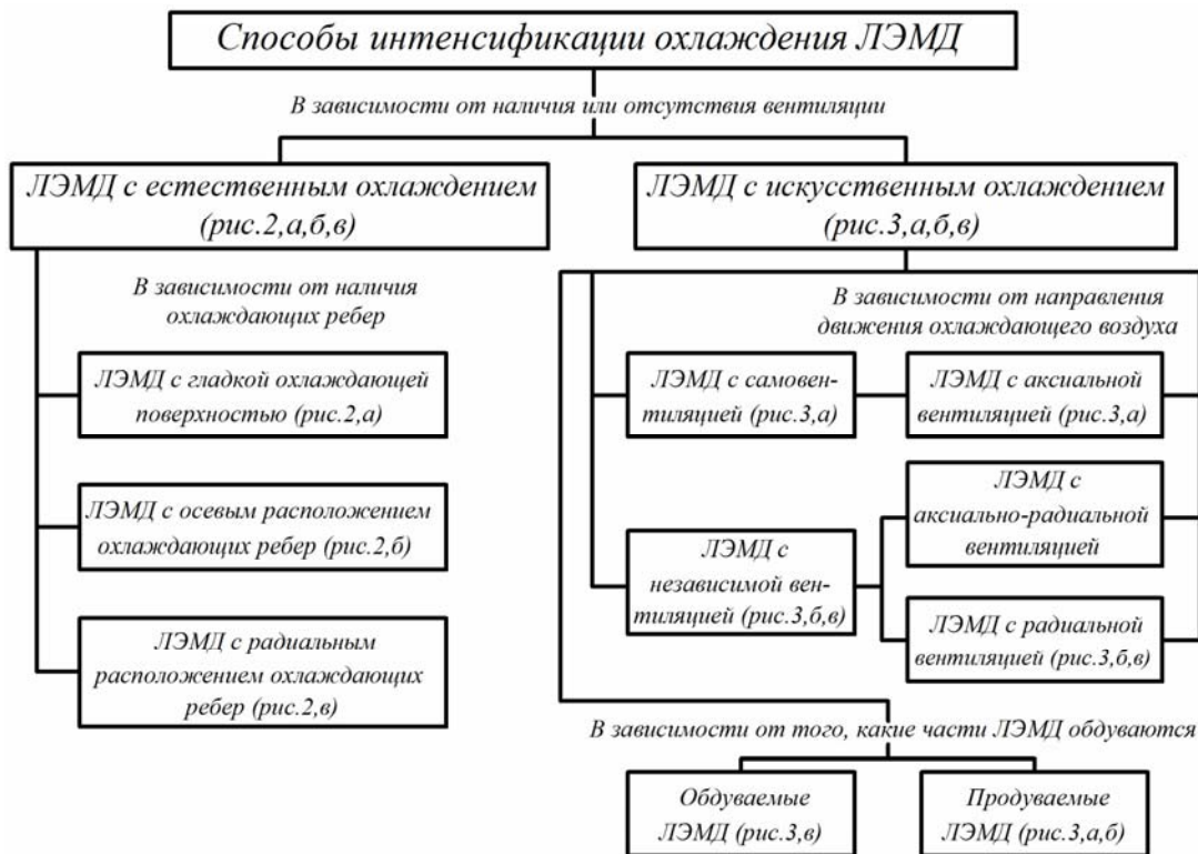
Рис. 1. Классификация способов интенсификации охлаждения ЛЭМД
