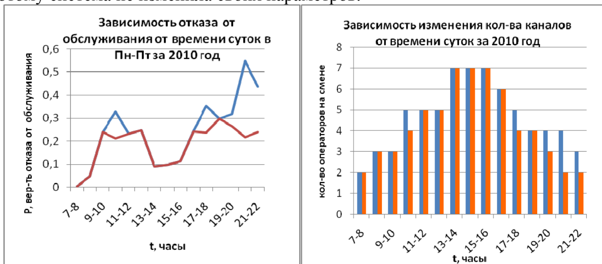
Рис. 5. Обобщенные графики зависимости вероятности отказов в обслуживании и изменение количества операторо-часов от времени суток в рабочие дни за 2010 год
