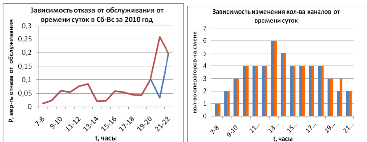
Рис. 7. Обобщенные графики зависимости вероятности отказа в обслуживании и изменение количества операторо-часов от времени суток в выходные дни за 2010 год
