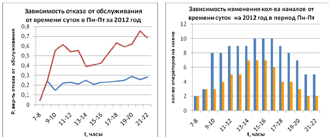
Рис. 6. Обобщенные графики зависимости вероятности отказов в обслуживании и изменение количества операторо-часов от времени суток в рабочие дни за 2012 год
