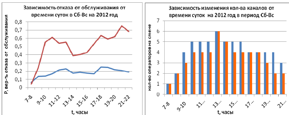
Рис. 8. Обобщенные графики зависимости вероятности отказа в обслуживании и изменение количества операторо-часов от времени суток в выходные дни за 2012 год
