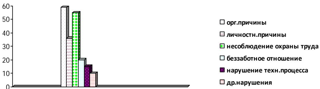
**Рис. 1. Анализ причин производственного травматизма на угледобывающих предприятиях**
